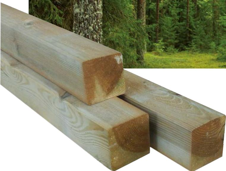
Il trattamento di impregnazione viene effettuato con liquidi senza cromo e arsenico (normativa DIN 68800/3). La tolleranza dimensionale è di 25 mm sulla lunghezza, 5 mm sulla larghezza e 2 mm sullo spessore. I listelli possono presentare fenditure longitudinali dovute all'essiccazione del legno, sono esclusi nodi cadenti e nodi con diametro superiore al 30 % della larghezza del pezzo. Sono tollerate curvature sino a un massimo dell'8 %.
